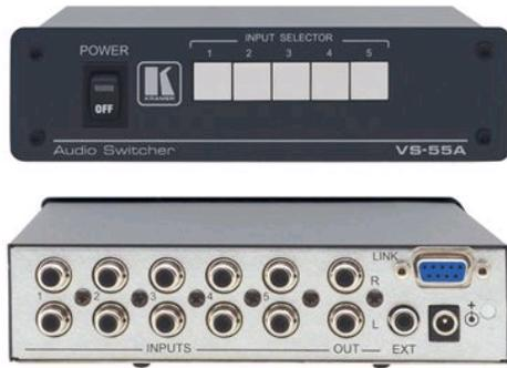
Der Kramer VS-55A ist ein kompakter High-Performance Umschalter für unsymmetrische Stereoton-Signale. Er schaltet eines von fünf Stereoton-Signalen auf einen einzelnen Ausgang.
